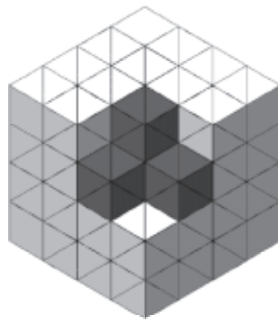
Rysunek 23. Siatka optymalna dostarczająca rozwiązanie z dokładnością 1% błęd względnego w normie energetycznej uzyskana po 6 iteracjach. (Optimal grid after providing solution with 1% relative error in energy norm, obtained after 6 iterations).
