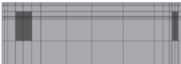
Rysunek 36. 16 elementów siatki początkowej złożonej ze 128 elementów, pokrywających obszary największych osobliwości. (16 initial mesh elements covering areas with strongest singularities, from initial mesh having 128 elements).
