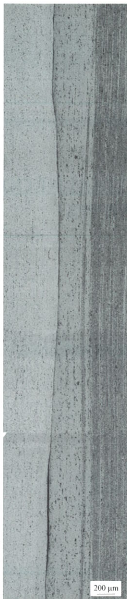
Rysunek 19. Topografia strefy kontaktu między stopem AA2014 a stopem AA6063 utworzonym podczas jednoczesnego wyciskania.
