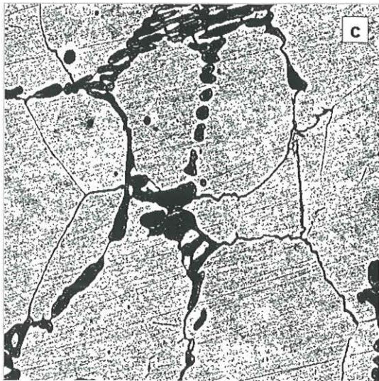
Rysunek 5. Wykorzystanie metody binaryzacji z histerezą do detekcji węglików oraz granic ziarn byłego austenitu w stali narzędziowej do pracy na gorąco. Opis w tekście.
