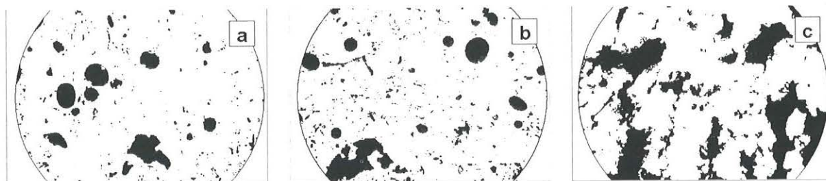
Rysunek 22. Końcowe obrazy binarne porów uzyskane za pomocą metody II. Opis w tekście.
