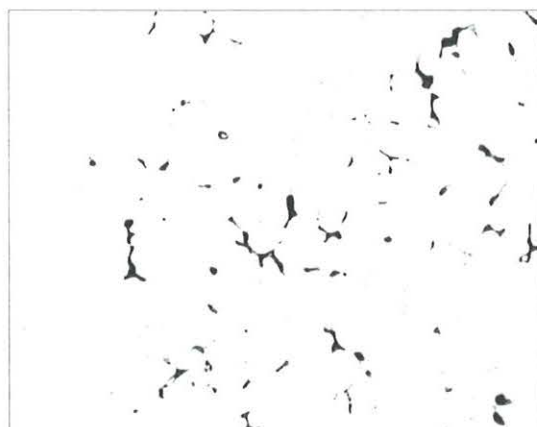
Rysunek 3. Obraz mikroporów na polerowanym zglądzie próbki z żarowytrzymałego stopu niklu RENE77 oraz histogram poziomów szarości tego obrazu.
