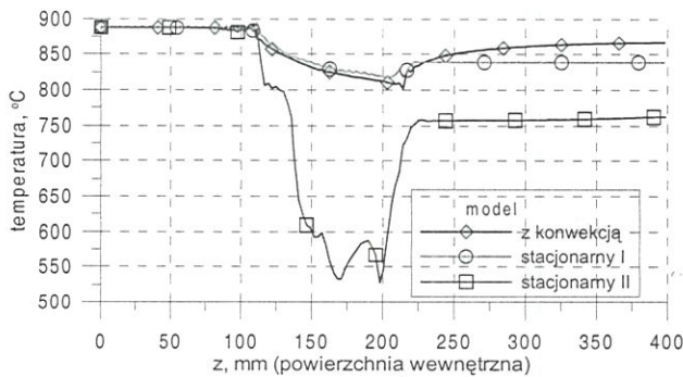
Rysunek 17. Przebiegi zmian temperatury, wyznaczone testowanymi modelami, na powierzchni wewnętrznej tulei w procesie wydłużania tulei II. Wyznaczone testowanymi modelami z pominięciem źródła ciepła i ciepła tarcia.
